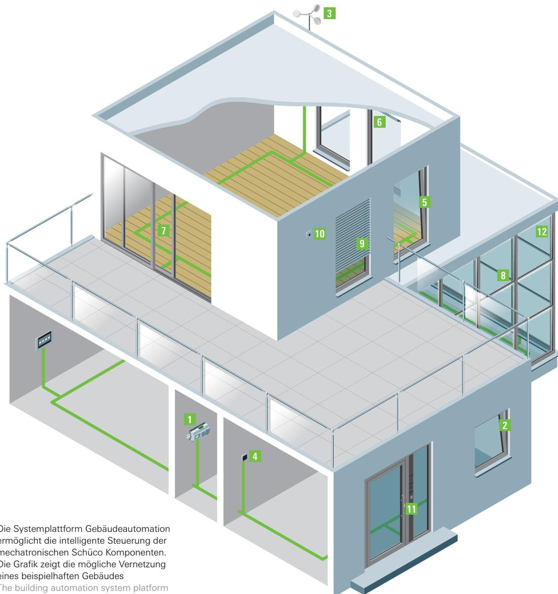
Die Systemplattform Gebäudeautomation ermöglicht die intelligente Steuerung der mechatronischen Schüco Komponenten. Die Grafik zeigt die mögliche Vernetzung eines beispielhaften Gebäudes
