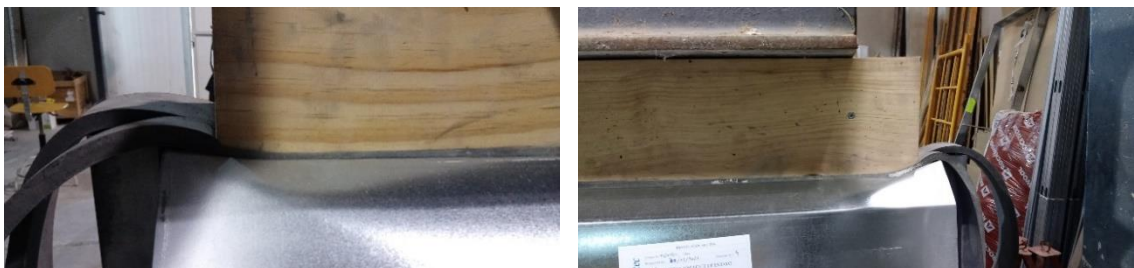
Detalle de la deformación en el cabezal en los extremos
